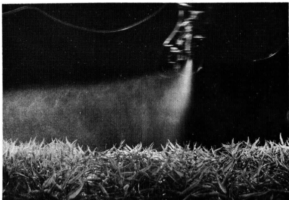
Bild 2. Strahlbild mit Strahlschleppe für Teejet 11003 bei 5 bar Spritzdruck und 10 km/h Fahrgeschwindigkeit (Höhe über Bestand 50 cm)
