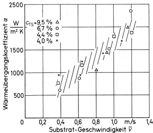
Bild 6. Wärmeübergangskoeffizient für Flüssigmist in Abhängigkeit von der mittleren Substratgeschwindigkeit bei verschiedenen Trockensubstanzgehalten.
