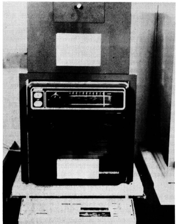
Bild 9. Mikrowellentrocknungseinrichtung zur Feuchtegehaltsbestimmung.
