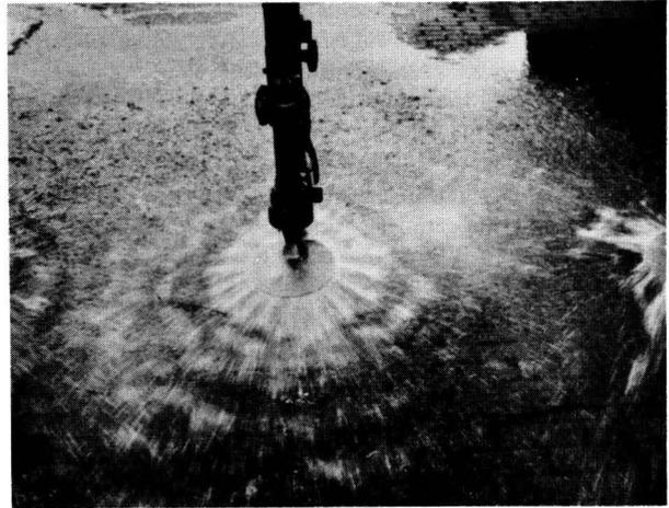
Bild 14. Ausbildung einzelner Stromfäden am Prallteller.
