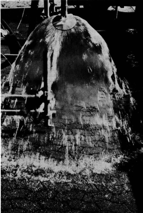
Bild 9. Ausbildung einer glockenförmigen Flüssigkeitsmembran.
