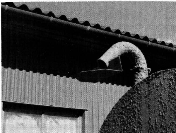
Bild 3. Tankwagen mit hoch angebrachtem Prallteller.
