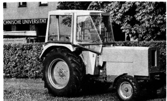
Bild 15. Versuchsschlepper in Halbrahmenbauweise mit motorferner Kapselung; Schleppervariante C.
