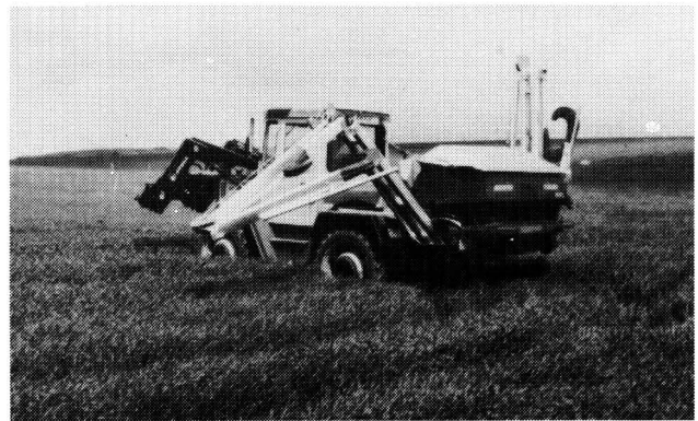
Bild 20. Düngerstreuer mit Schrägschaufel-Endverteilern und hydraulisch klappbaren Seitenauslegern.
