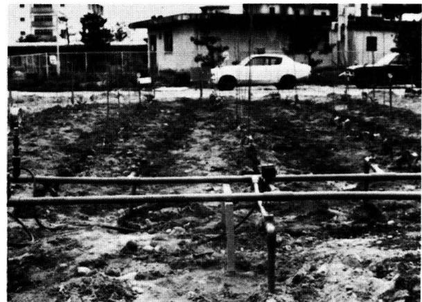
**Bild 7.** Pflanzen auf der Versuchsfläche mit Untergrundrohrsystem, im Vordergrund ein Teil der Zuleitungen.
