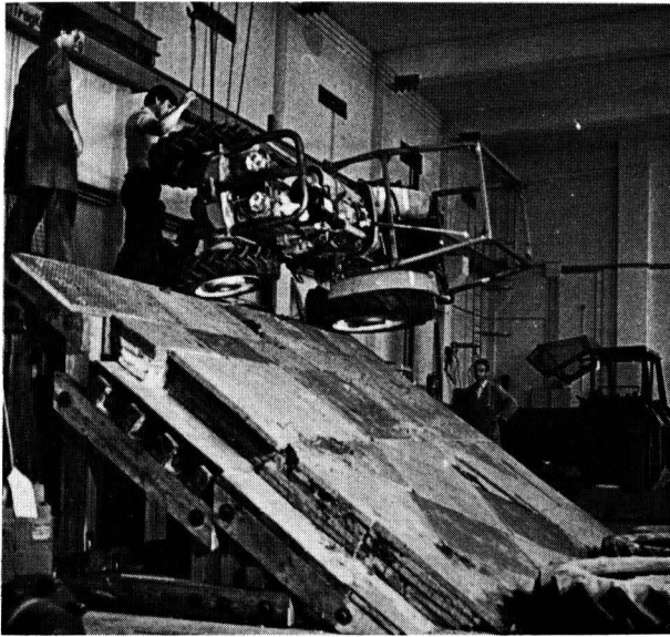
Bild 14. Umsturzhang für Schmalspurschlepper im Institut für Landmaschinen der TU München.
