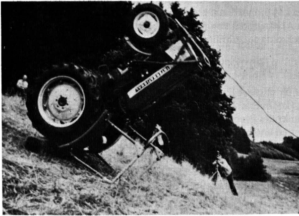
Bild 4. Rückwärtiger Schlepperumsturz am Hang 1 : 2.
