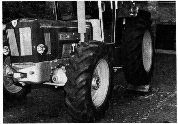
Bild 13. Messung der Drehbeschleunigung eines Schleppers beim Überfahren eines trapezförmigen Hindernisses (Höhe 180 mm, Länge 800 mm, Auffahrwinkel 30^\circ ).
