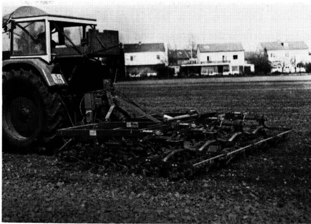
Bild 4. Zugkraftmessung an einer Saatbettkombination.
