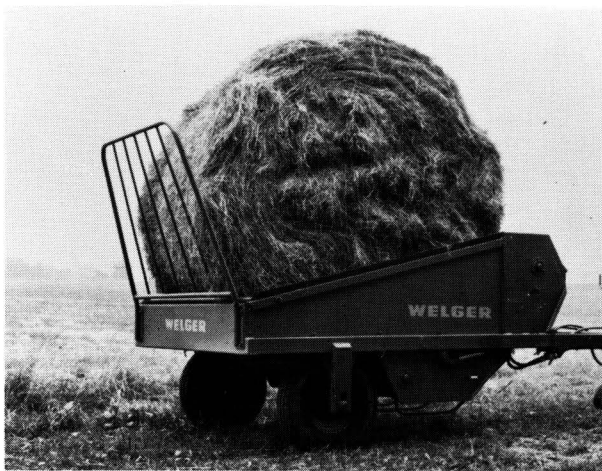
Bild 2. Ballen-Auflösegerät für Rollballen. (Werkbild: Fa. Welger)
