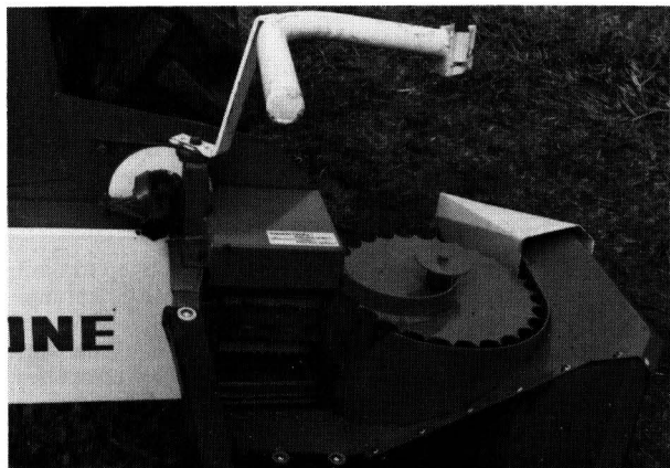
Bild 5. Leichter einreihiger Anbauhäcksler für Mais. (Werkbild: Fa. Krone)
