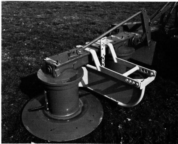
Bild 1. Mähwerk mit Zettvorrichtung. (Werkbild: Fa. Zweegers en Zonen)
