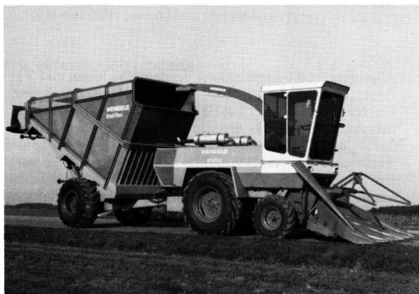
Bild 6. Selbstfahrender Feldhäcksler mit 4reihigem Maisgebiß, hydrostatischem Fährantrieb, 196 kW. (Werkbild: Fa. Mengele)
