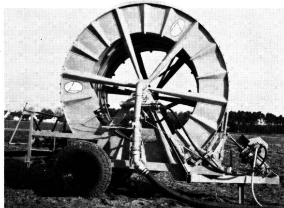
Bild 1. Beregnungsmaschine mit Regneranzug. Die Rohrtrommel kann 430 m Rohr (PE-S) mit 110 mm Außendurchmesser aufnehmen, Hubzylinder-Antrieb. (Werkfoto: Fa. Hüdig).
