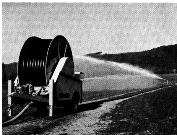
Bild 2. Beregnungsmaschine mit Regneranzug. Die Rohrtrommel kann 400 m Rohr (PE-S) mit 110 mm Außendurchmesser aufnehmen, Turbinenantrieb, vordere Abstützung hydraulisch zu betätigen. (Werkfoto: Fa. Beinlich).
