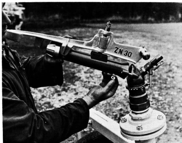
Bild 4. Starkregner mit auswechselbarem Strahlrohr. Strahlanstiegswinkel je nach Strahlrohr 30° oder 23°. (Werkfoto: Fa. Perrot)
