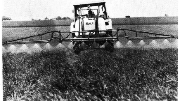
Bild 1. Pendelnd und reibungsarm aufgehängte Düsenbalken mit einer Möglichkeit der Hanglagenanpassung finden sich im Herstellungsprogramm aller namhaften Hersteller. (Werkbild: Fa. Rau)
