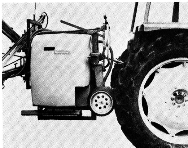
Bild 2. Steuerungs- und Regeleinrichtungen zur Einhaltung einer gleichen Verteilungsdichte auch bei schwankender Fahrgeschwindigkeit werden bereits in vielfältiger Form angeboten. Tecnomat zeigte für ein Schlepperanbau-Spritzgerät eine Abtastung der Fahrgeschwindigkeit durch ein Reibrad. (Werkbild: Fa. Tecnomat)
