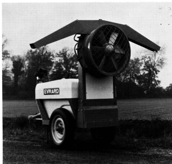
Bild 4. Bei Raumsprühgeräten werden die Forderungen nach verminderter Abdrift bei gleichzeitiger Verbesserung der Anlagerung deutlicher. Ein hochgesetztes Axialgebläse mit konventioneller Ausströmung und Strahlabschirmung nach oben ist ein erster Ansatz in dieser Richtung. (Werkbild: Fa. Evrard)
