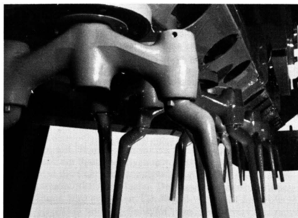
Bild 2. Kreiselegge, deren Zinken ausschwenken können. (Werkbild: Fa. Krone)
