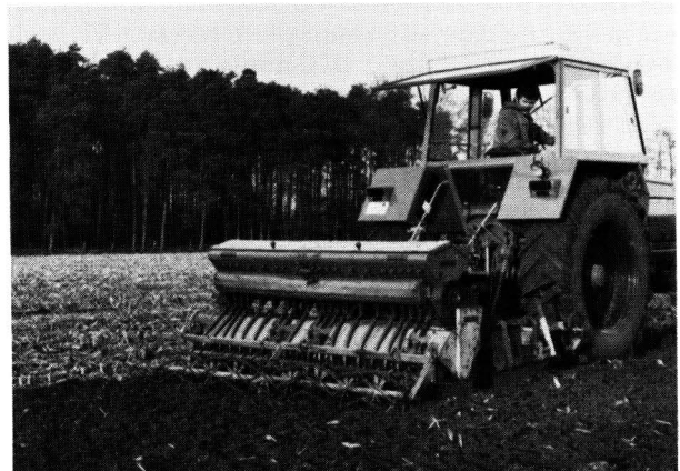
Bild 4. Kombination von Kreiselegge, Packerringen und Sämaschine. (Werkbild: Fa. Köckerling)
