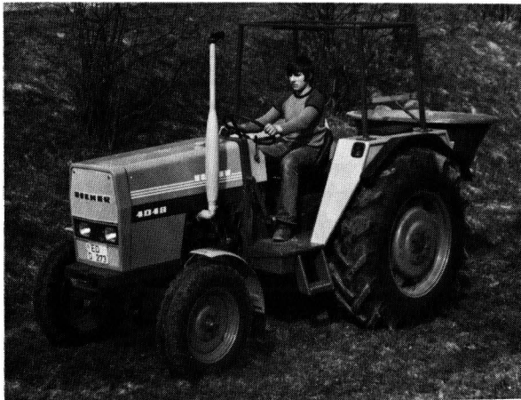
Bild 8. Eicher-Schlepper mit integrierter Sicherheitsplattform; 35 kW. (Werkfoto: Fa. Gebr. Eicher)
