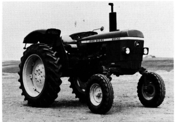
Bild 13. Schlepper mit einstellbarer Bodenfreiheit: John Deere 2030 "Multicrop".
