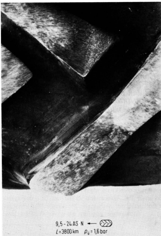
Bild 12. Zipfelbildung und Gleitrichtungen beim Reifen 9,5-24 AS N.
