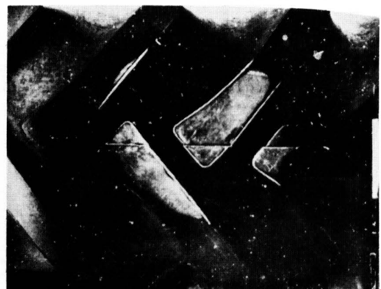
Bild 2. Profilabdruck eines Reifens 10,5–18 MPT bei einem Reifennendruck von 1,75 bar und einer Belastung von 294 daN.
