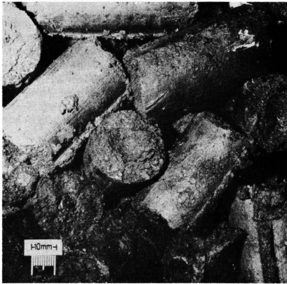
Bild 3. Gemenge aus Rückgut und Flüssigmist (Rind) in Preßlingsform.
