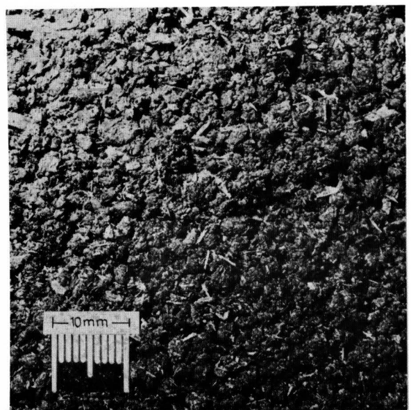
Bild 2. Gemenge aus Rückgut und Flüssigmist (Rind) in Krümelform.
