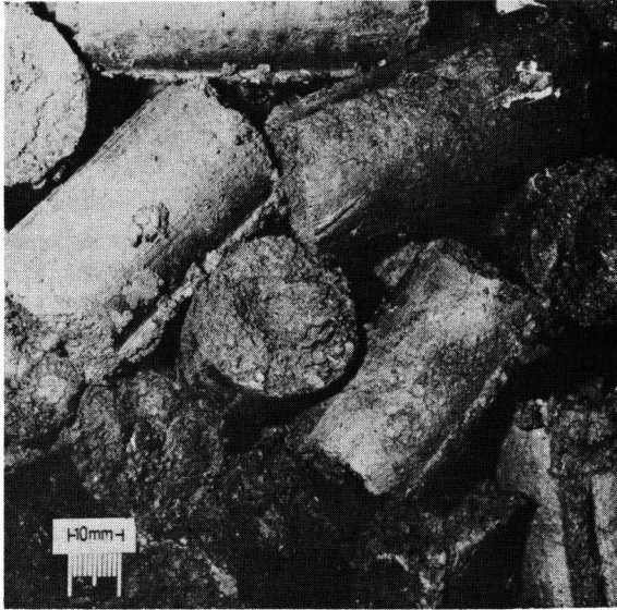
Bild 6. Preßlinge, hergestellt mit Schneckenpresse der Bauart a (s. Tafel 1).
