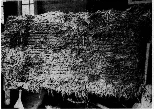
**Bild 17.** Ausschnitt aus der Fräsfläche des Frässtreuwerts. (Ansicht der gefrästen Dungfläche von der Rückseite des Dungstreuers).
