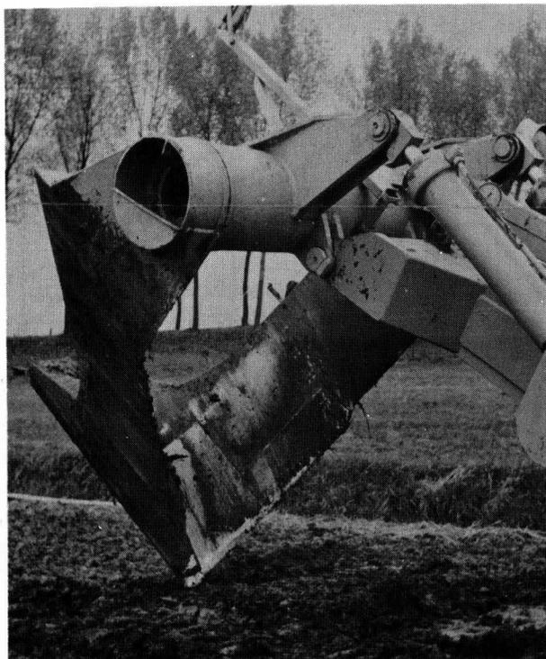
Bild 3. Dränpflug von *Willner* in V-Form montiert an einer Planier-
