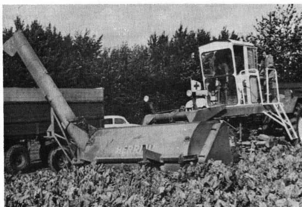
Bild 7. Kurzblattüberladeschnecke an 6reihiger Köpfmaschine.
