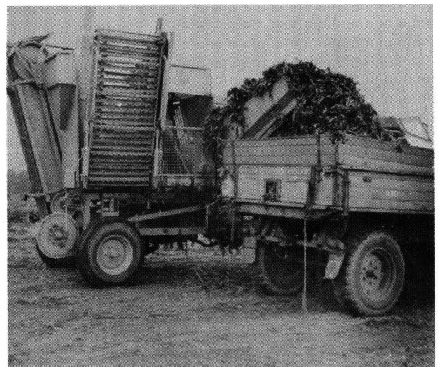
Bild 5. 1reihige Erntemaschine für Rüben und Blatt bei der Entleerung des Blattbunkers. Werkfoto: Kleine
