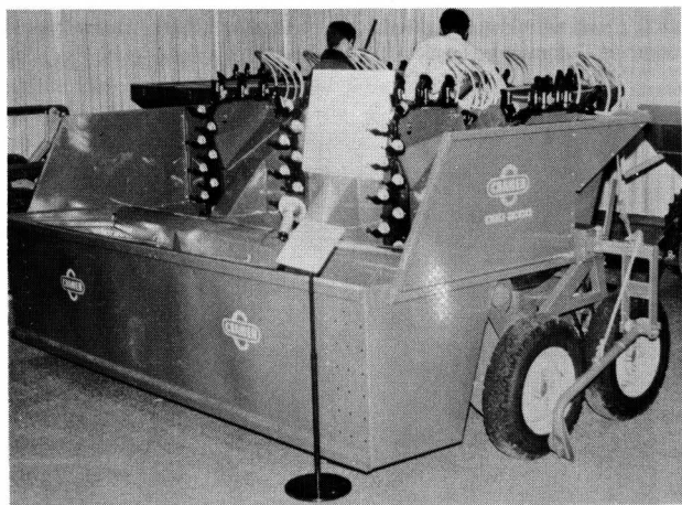
Bild 1. Vierreihige Anbaulegemaschine mit löffelartiger Schöpfleinrichtung und waagerechter Vereinzelungsstrecke.
