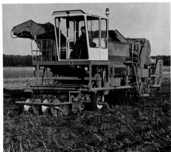
Bild 6. Zweireihiger Selbstfahrer mit Dammaufnahme vor den Vorderrädern.
