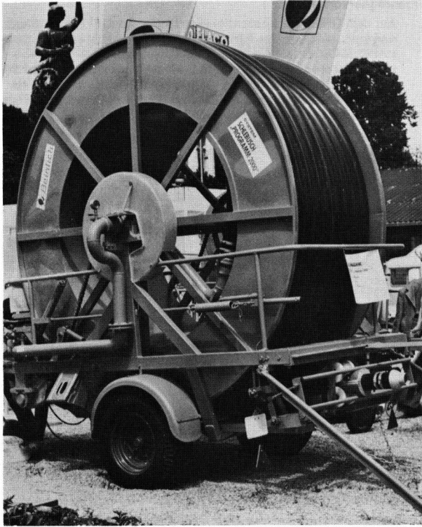
Bild 4. Beregnungsmaschine mit Regnereinzug; Trommelanordnung parallel zur Fahrgestellachse. (Beinlich – Programm 2000)
