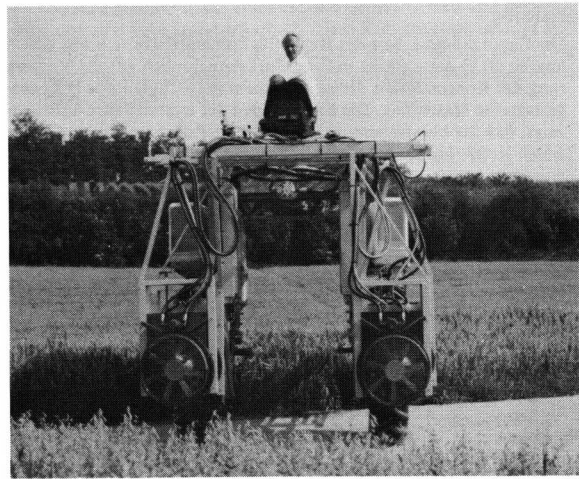
Bild 6. Stelzentraktor mit 2 Sprühgeräten. Werkfoto: Firma Groll/BOB, Landau
