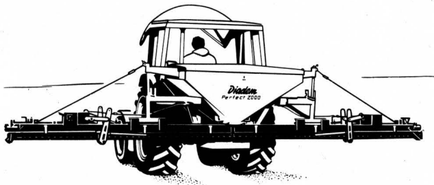
Bild 5. Stallungstreuer mit pendelndem Streuwerk. Werkfoto: Firma Krone, Spelle
