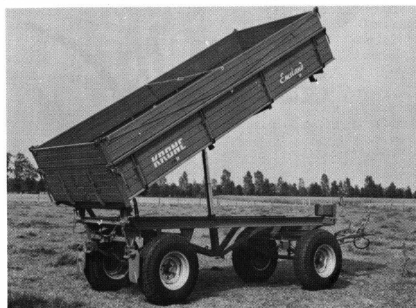
Bild 2. Hochabladeeinrichtung am Dreiseitenkipper mit einem abnehmbaren Zwischenstück. Werkfoto: Firma Krone, Spelle
