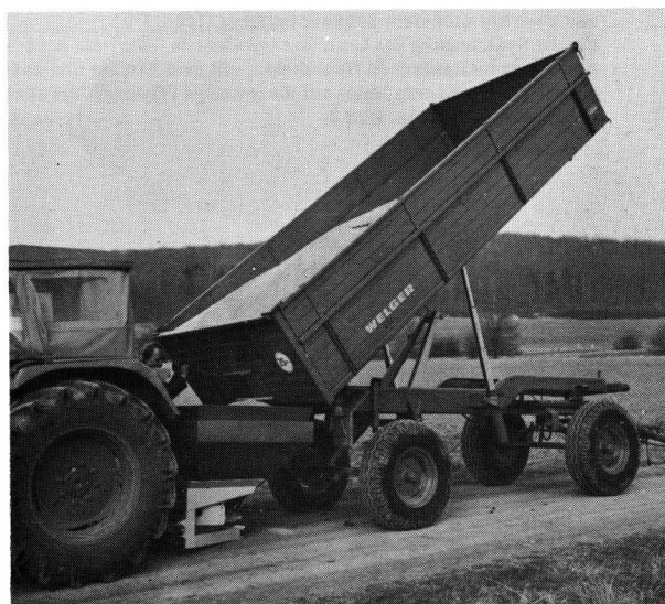
Bild 1. Hochabladeeinrichtung am Dreiseitenkipper mit einer Zusatzschwinge. Werkfoto: Firma Welger, Wolfenbüttel
