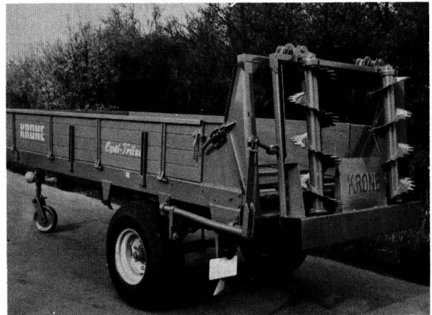
Bild 5. Stallungstreuer mit pendelndem Streuwerk. Werkfoto: Firma Krone, Spelle
