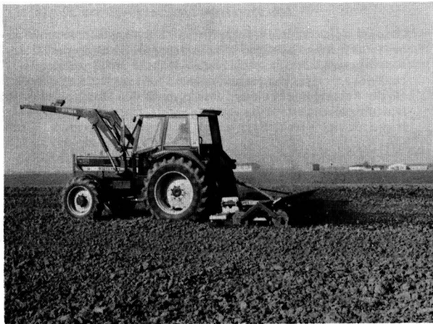
Bild 3. Starreggen – Wälzegen-Kombination mit Zwangsschlupf der Wälzegen.
