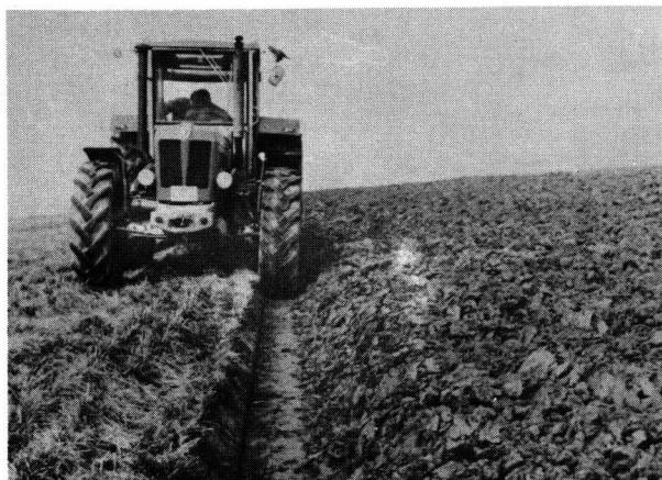
Bild 1. Furchenräumung durch den Rautenpflug. Werkfoto: Gassner, Göggenhofen
