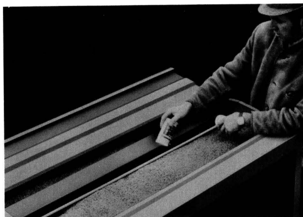
Bild 5. Drillmaschine mit Dosiereinrichtung für ein kontinuierliches Beizen des Saatgutes während des Drillens mittels einer Pendelwelle. Der Beizmittelvorratsbehälter befindet sich innerhalb des Saatkastens.
