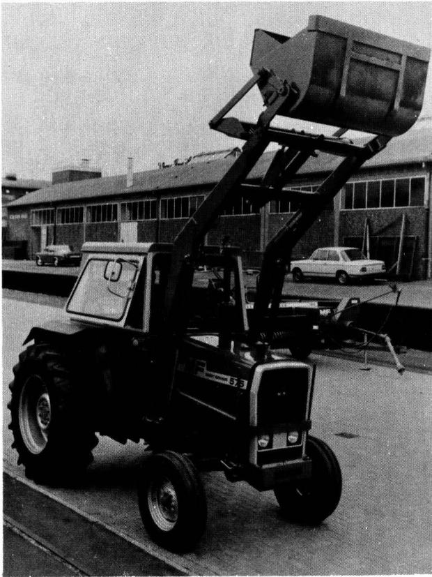
**Bild 1.** Vollintegrierte Sicherheitskabine am Mittelklassenschlepper MF 575 (48,5 kW).
