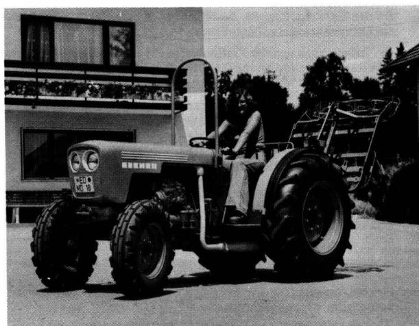
Bild 7. Eicher 48-kW Schmalspurschlepper.
