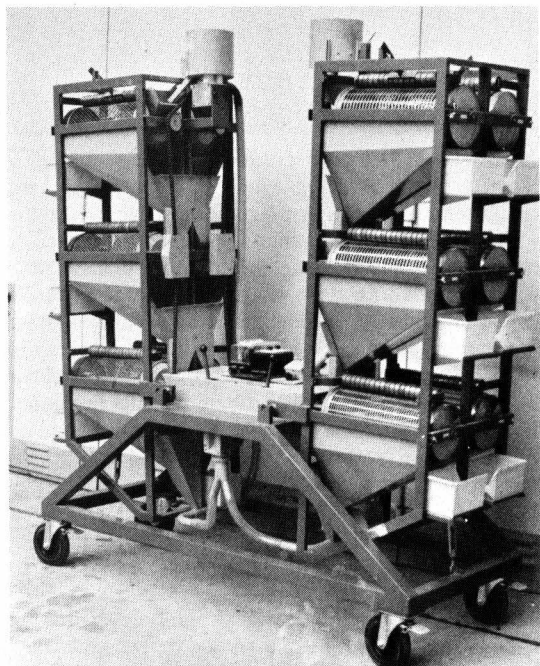
Bild 1. Laborsiebmaschine zum Aufbereiten des Saatgutes in Klassen bestimmter Kornbreiten ( \emptyset ) und Korndicken ( \neq ).
