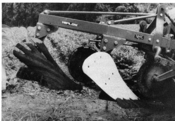
Bild 8. Pflug mit Streichblech aus Kunststoff.
