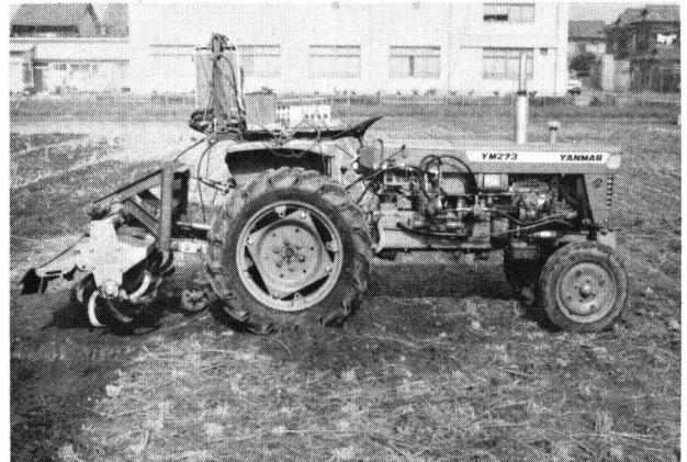
Bild 5. Hydrostatisch angetriebener Schlepper für Feldversuche zur kombinierten Regelung der Fahrgeschwindigkeit und der Arbeitstiefe der Bodenfräse.
