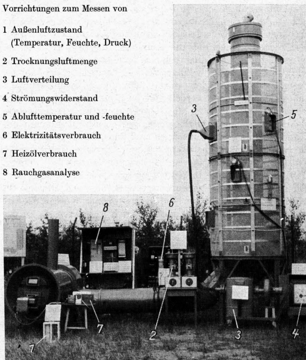
Bild 1. Warmluftstättrockner mit Zentralrohrbehälter auf dem DLG-Prüfstand (DLG-Ausstellung Hannover 1964).
