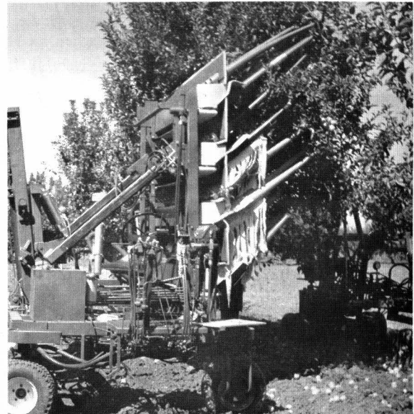
Bild 4. Selbstfahrende Maschine mit aufblasbaren Armen (Versuchsgerät) für die maschinelle Ernte von Frischobst.
