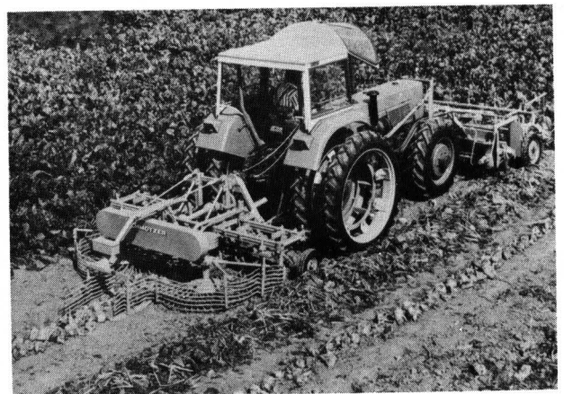
Bild 3. Schwerer Allradschlepper mit Frontköpfer und Dreipunkt-Längsschwadroder, Hinterachse mit schmalen Doppelreifen. Werkbild Schmotzer
