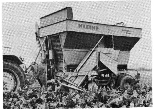
Bild 2. 1-rhg. gezogener Bunkerköpfröder mit Rüben- und Blattbunker für gehäckseltes Blatt. Werkbild Kleine
