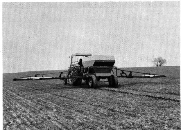
**Bild 5.** Pneumatischer Düngerverteiler. Amazonen-Werke, Hasbergen-Gaste
