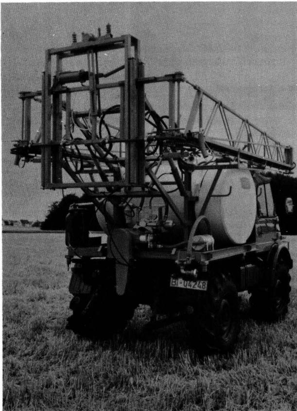
**Bild 6.** Aufbau-Spritzanlage in Transportstellung. Fricke, Bielefeld
