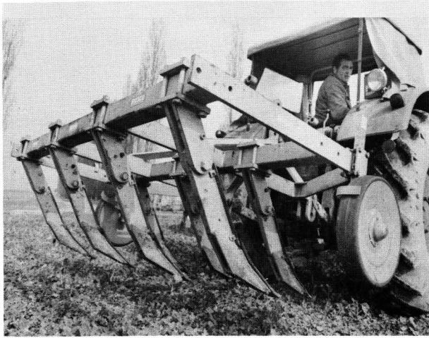
Bild 1. Tiefgrubber mit nach vorn geneigten Zinken. Werkbild: Brenig, Bonn-Bad Godesberg
