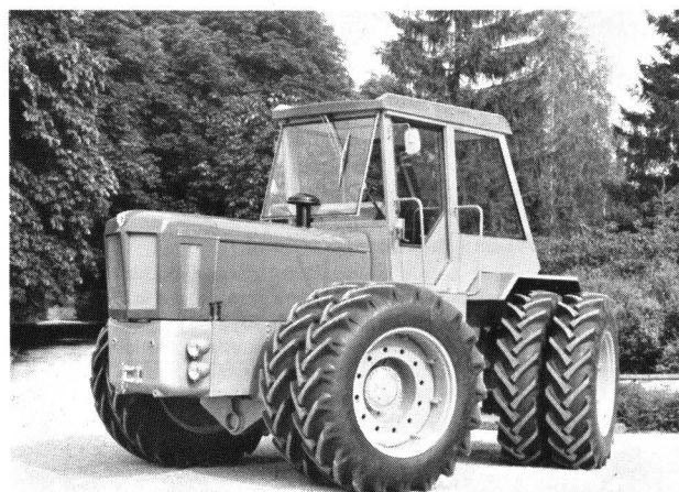
Bild 5. Schlüter "Profi Trac" 3000 TVL; 206 kW mit 2-Rad-, 4-Rad- und "Hundegang"-Lenkung.
