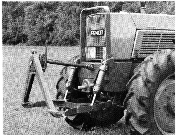
Bild 1. Front-Kraftheber und voll unabhängige Frontzapfwelle (540 und 1000 min -1 ) an Fendt-Schlepper.
