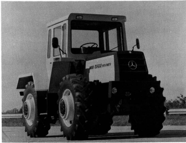
Bild 6. MB-Trac 95/105; 70 kW 16-Gang-Wendegetriebe und reversierbarem Fahrerpodest, gefederter Vorderachse, ausziehbarem Motor-Hilfsrahmen und seitlich hochstellbarer Kabine. Bereifung: 4 x: 13,9-30, 9,5-36 oder 14,9-30
