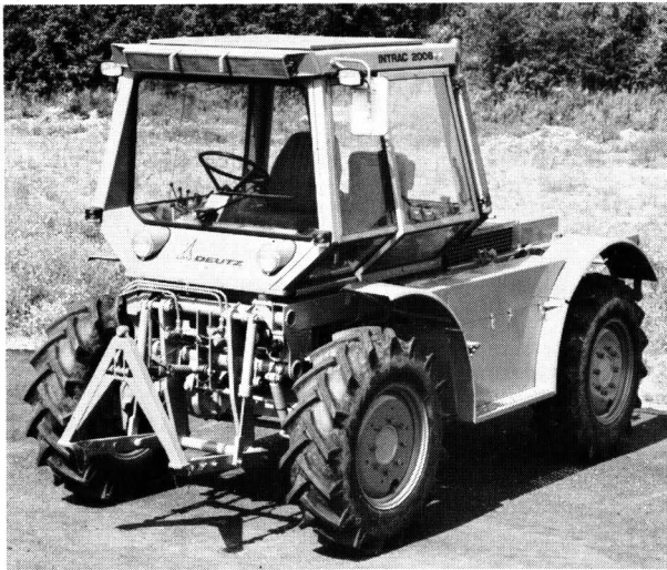
Bild 7. Deutz "Intrac 2006"; 85 kW, mit hydrostatischem Fahrtrieb und gefederter Vorder- und Hinterachse. Bereifung: 4 x: 14,5-24 oder 10,5-28
