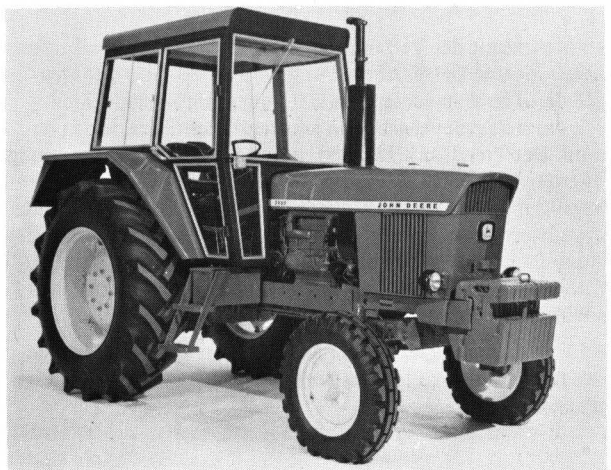
Bild 10. Kabine auf Schlepper gehobener Leistung mit integriertem Überschlachtschutzrahmen und schallsolierender Innenbekleidung (John Deere).
