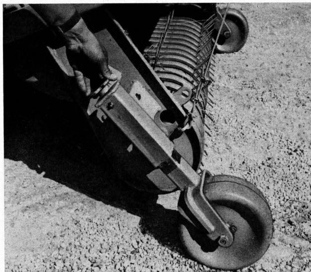
**Bild 6.** Beispiel für eine einfache werkzeuglose Verstellung der Tasträder der Pick-up über Schraubspindel und Handdrehgriff.
