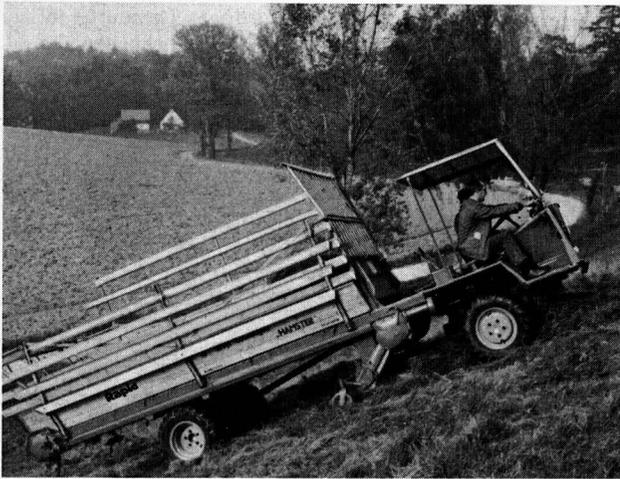
**Bild 7.** Selbstfahrender Ladewagen beim Einsatz an einem 50% steilen Hang.
