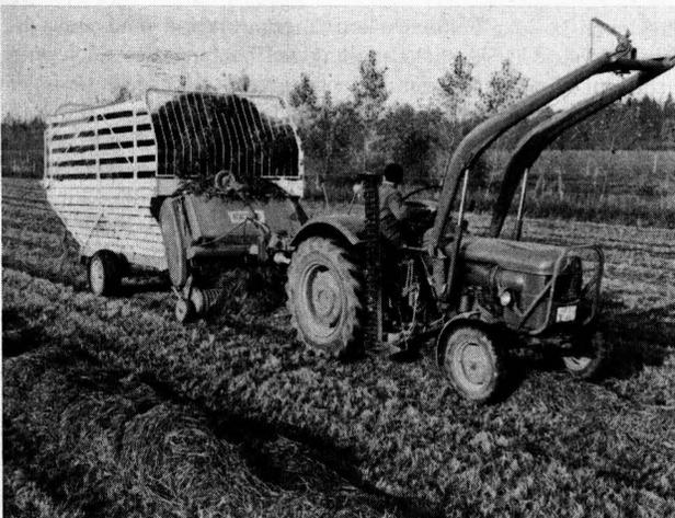
**Bild 8.** Ladewagen mit Dürrgutaufbau für das Laden von Heu aus großen Schwaden.
