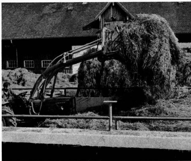
**Bild 12.** Einstapeln von schnellentleertem Ladewagengut mit Frontlader und Abschiebegabel in Flachsilo.
