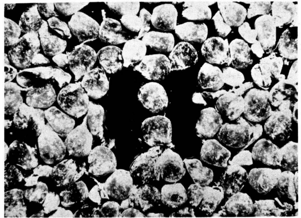
Bild 9. Aufnahme einer mit Propionsäure und Fluoreszenzpigment behandelten Körnerprobe. Zum Vergleich sind in der Bildmitte sechs unbenetzte Körner beigefügt.
