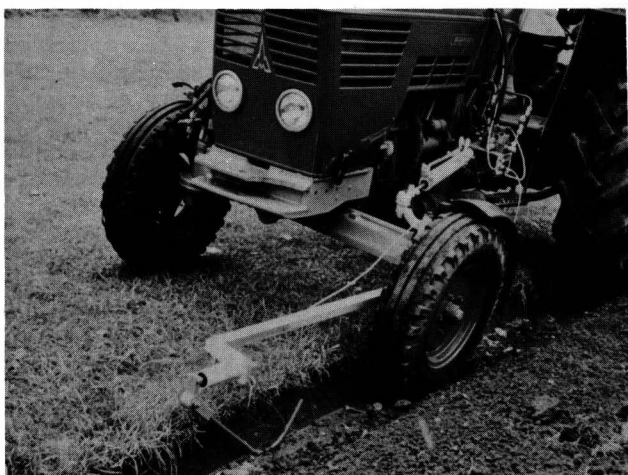
Bild 5. Vorrichtung zum Abtasten einer Pflugfurchen.
