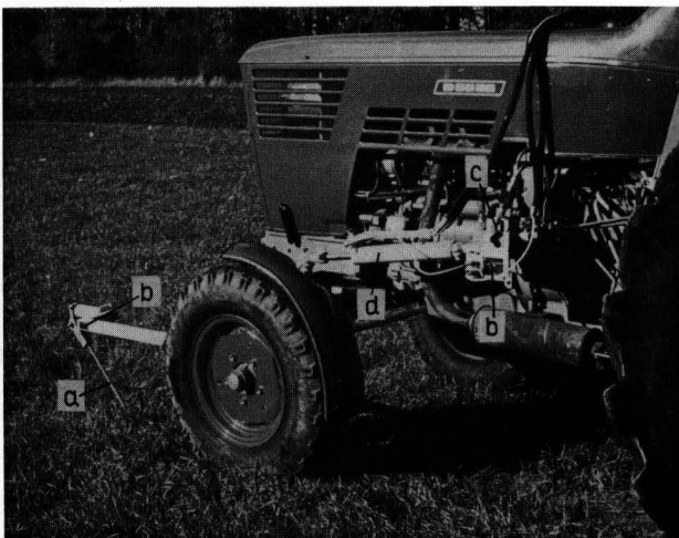
Bild 9. Ansicht der gesamten Anordnung zur automatischen Schlepperlenkung.
