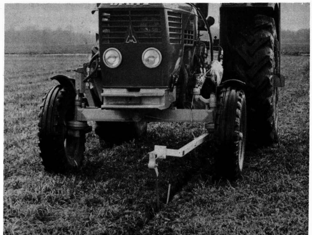
Bild 6. Fühler zum Abtasten einer Leittrille.
