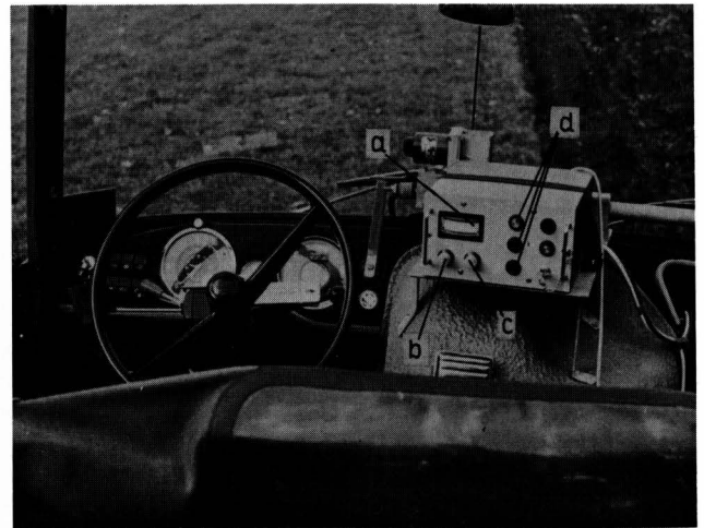
Bild 2. Schaltelemente für eine elektrohydraulische Pflugtiefenregelung
