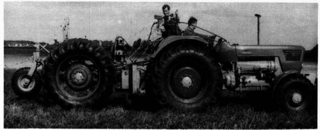
Bild 2. Einzelrad-Meßvorrichtung zur Ermittlung des Betriebsverhaltens von AS-Triebrifen unter natürlichen Einsatzbedingungen.
