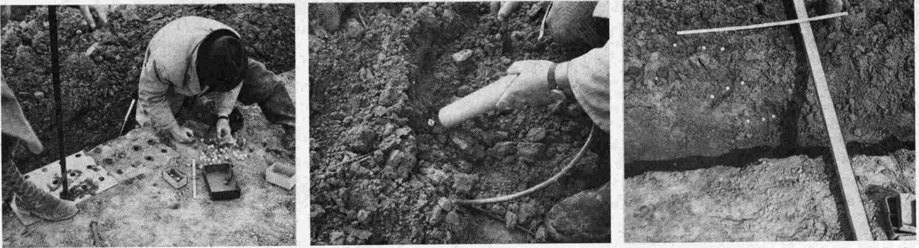
**Bild 9 bis 11.** Messen des Winkels der Wendung des Furchenbalkens durch Einlegen von Meßkörperchen mit Kobalt-Isotopen in die Bodenoberfläche.
