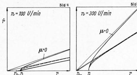
**Bild 4 und 5.** Radialgeschwindigkeit  $\dot{r}$  auf einer Schleuderscheibe in Abhängigkeit vom Radius  $r$  bei zwei verschiedenen Scheibendrehzahlen  $n$ .
