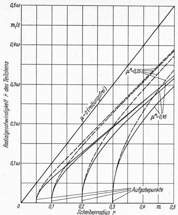
**Bild 8.** Radialgeschwindigkeit auf einer Schleuderscheibe in Abhängigkeit vom Radius für Scheibendrehzahlen über 300 U/min und zwei Scheinreibbeiwerte  $\mu^*$ .
