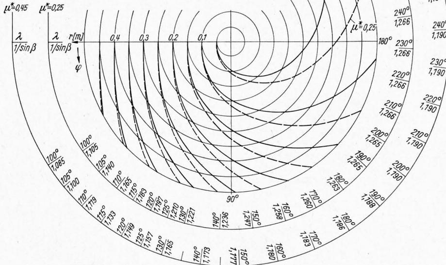
**Bild 10.** Teilchenbahnen auf einer Streuscheibe für Scheibendrehzahlen über 300 U/min und zwei Scheinreibbeiwerte  $\mu^*$ .
