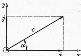
**Bild 11.** Komponenten der Teilchenfluggeschwindigkeit.
