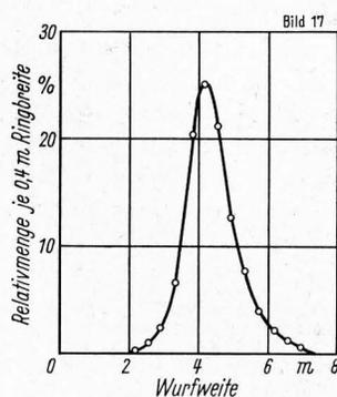
**Bild 16. und 17.** Radialverteilung in einem Streuring.
