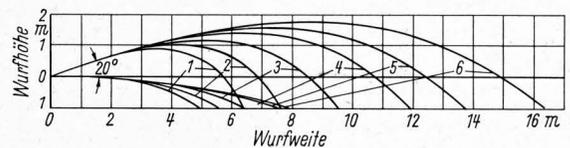
**Bild 20.** Einfluß des Abwurfwinkels auf die Wurfweite bei horizontalem und schiefem Abwurf unter  $20^\circ$  für  $v_A = 20$  m/s.
