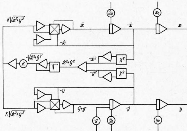
**Bild 13.** Rechenschaltung für die Ermittlung der Teilchenflugbahnen.
