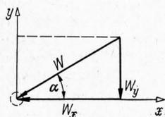
**Bild 12.** Komponenten des Luftwiderstandes.
