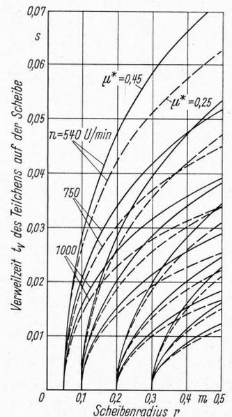
**Bild 9.** Verweilzeit auf einer Schleuderscheibe in Abhängigkeit vom Radius für drei Scheibendrehzahlen  $n$  und zwei Scheinreibbeiwerte  $\mu^*$ .
