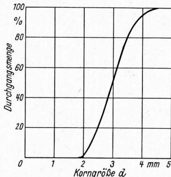
**Bild 15.** Durchgangssummenverteilung von Superphosphat A [2].
