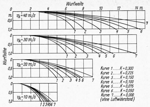
**Bild 14.** Wurfweite in Abhängigkeit von der Abwurfgeschwindigkeit für verschiedene  $K$ -Werte.
