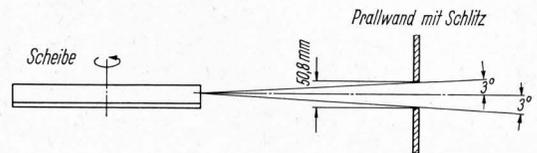
**Bild 18.** Versuchsanordnung zur Messung der Abwurfgenauigkeit [7].
