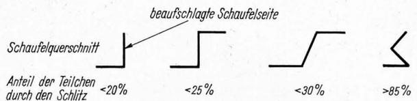
**Bild 19.** Einfluß der Schaufelform auf die Abwurfgenauigkeit [7].
