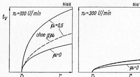
**Bild 6 und 7.** Verweilzeit  $t_V$  auf einer Schleuderscheibe in Abhängigkeit vom Radius  $r$  bei zwei verschiedenen Scheibendrehzahlen  $n$ .
