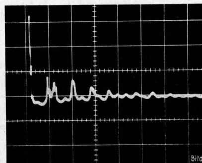
Bild 5. Oszillogramm von einem Aufprall eines Roggenkornes auf ein Mikrophon mit zusätzlicher mechanischer und elektrischer Dämpfung.
