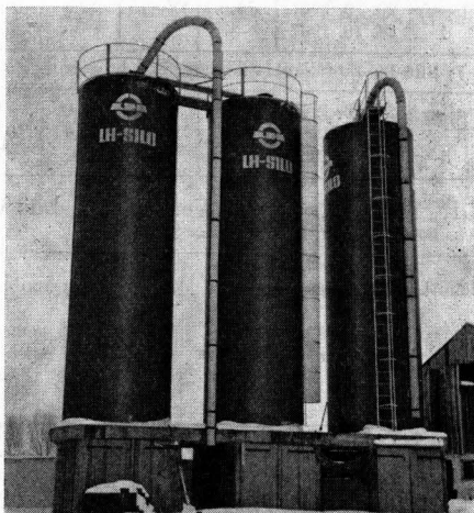
Bild 9. Prüfstand zur Messung der Wandreibungskräfte in Gärfuttersilos aus glasfaserverstärktem Kunststoff bei Untenentnahmetechnik.
