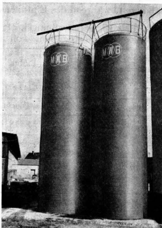
Bild 8. Prüfstand zur Messung der Wandreibungskräfte in Gärfuttersilos aus glasfaserverstärktem Kunststoff bei Obenentnahmetechnik.
