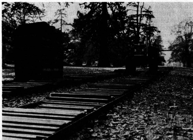
Bild 2. Fahrbahn mit künstlichen Unebenheiten zur Messung von Schwingungen am Fahrersitz.
