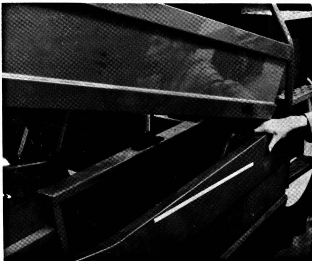
Bild 3. Quetschstelle zwischen Verkleidungen der Antriebe, alte Ausführung.
