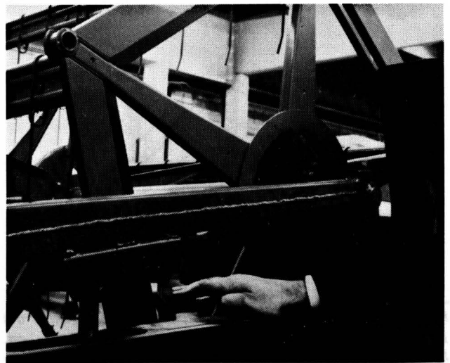
Bild 6. Gefahrenstelle zwischen Haspelstern und Tragkonstruktion der Haspel.
