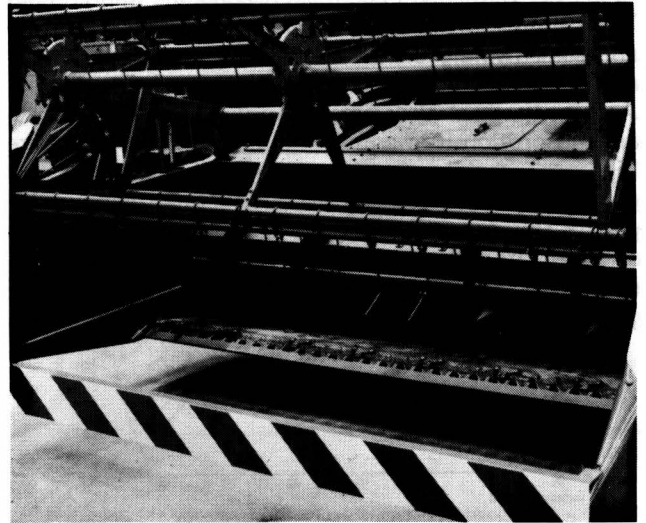
Bild 5. Einzugsschnecke eines Mähdreschers und Schutzbalken vor Mähmesser.
