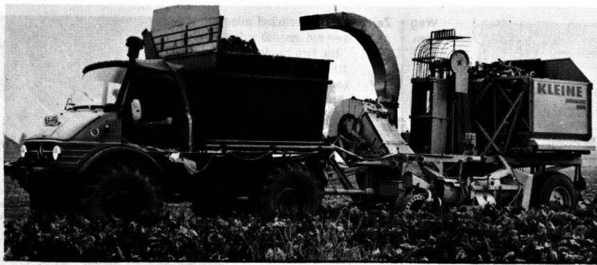
Bild 5. Bunkerköpfröder mit Einrichtung zur Kurzblattnerte, Blattbunker auf der Zugmaschine.
