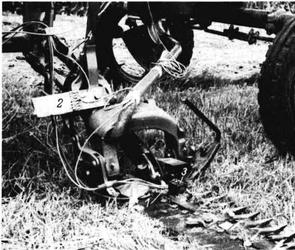
**Bild 12.** Messgeber am Versuchsmähwerk am Schlepper.
