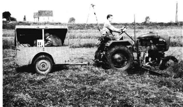
**Bild 17.** Bei den eigentlichen Versuchen mit verschiedenen Anbaumähwerken wurde ein Anhänger mit den Messgeräten unmittelbar von dem Versuchsschlepper mitgeführt.
