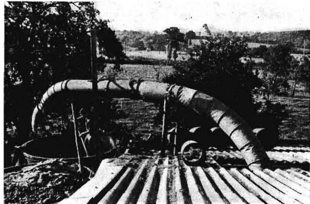
**Bild 11.** Förderung von Anwelksilage mittels einer Schlauchleitung aus nylon-verstärkter PVC-Folie.
