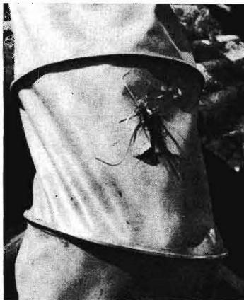
**Bild 10.** Schaden in einem Schlauchkrümmer nach Durchgang eines abgebrochenen Häckselmessers.
