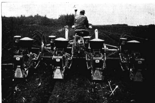
Bild 9. Vierreihiges Radsurpflanzen mit Schlepper nach Bild 8 bei gleichzeitigem Ausbringen von Dünger, Unkraut- und Insektenbekämpfungsmitteln.
