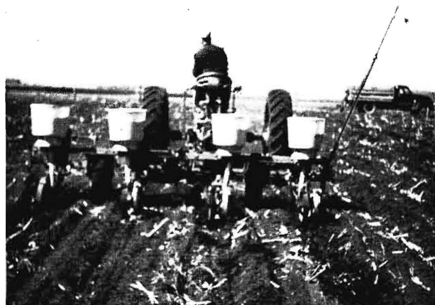
Bild 5. Vierreihiges Radspurpflanzen mit einem Dreiradschlepper.
