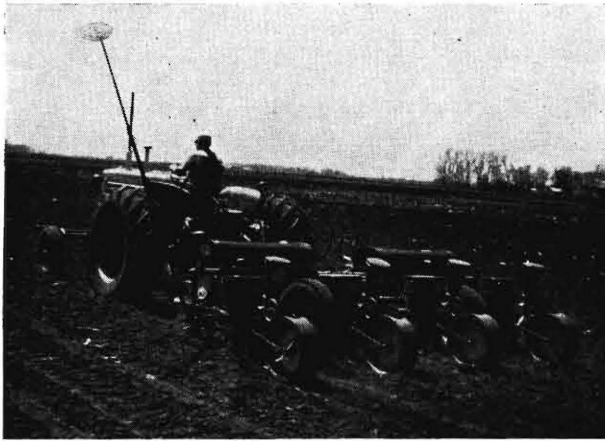
Bild 11. Gleichzeitiges, vierreihiges Maispflanzen und Ausbringen von Dünger- und Unkrautbekämpfungsmitteln außerhalb der Schlepperspuren.
