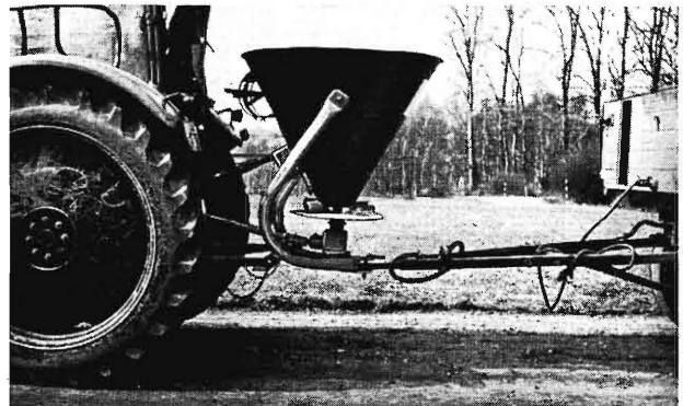
Bild 6. Der am angebauten Schleuderstreuer angehängte Ackerwagen gefährdet den Verkehr.
