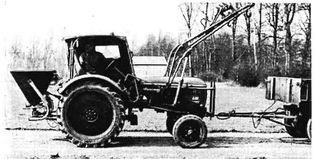
Bild 7. Straßentransport des am Heck angebauten Schleuderstreuers und des düngerbeladenen Ackerwagens am vorderen Zugmaul. Rückwärtsfahrt auf der Straße ist nach der Verkehrsordnung nicht zulässig.
