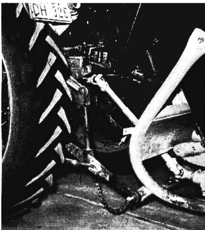
Bild 5. Bei dem Schleuderstreuer erschweren die zu tief liegenden Anschlußzapfen den Anbau. Scharfkantiges Anschlußstück (Pfeil) für den Staubschutz des Streuers gefährden den Mann beim Aufstieg.
