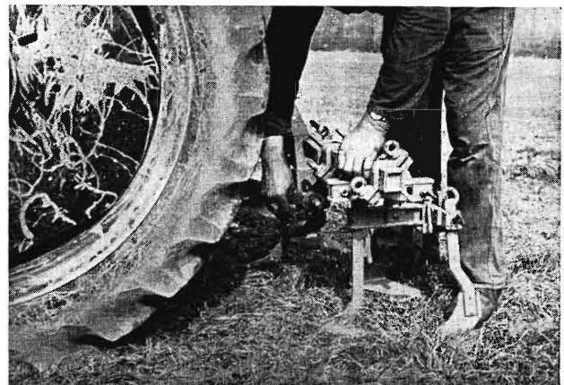
Bild 8. Das breite, kurz angebaute Anbauhackgerät kann vom Fahrer noch überstiegen werden.
