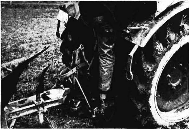
Bild 4. Das Auf- und Absteigen zur Einstellung des Anbaupfluges ist schwierig und nicht ungefährlich.
