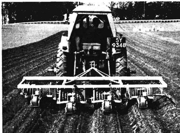
**Bild 15.** Vierreihiges Präzisionsdrillgerät zum Ausbringen des Saatgutes auf Dämmen.
