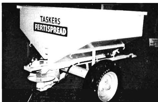
Bild 18. Schleuderdüngerstreuer mit hydraulisch angetriebener Schleuderscheibe.
