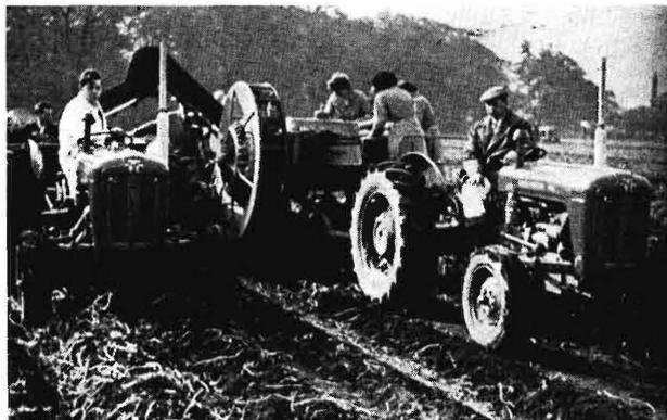
**Bild 10.** Einreihige Kartoffelerntemaschine.
